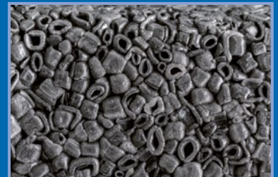
Schaumperlen in C-/Makkaroni-Form für geräuschreduzierende Anwendungen
